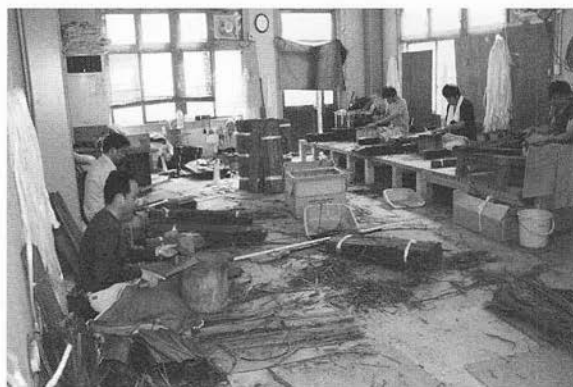
施工に備えて檜皮材料の準備・調整（村上社寺工芸で）
